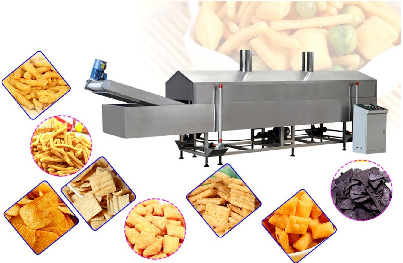
El sistema de alimentación adopta la regulación de la velocidad de conversión de frecuencia, con una fuerte potencia, operación estable y ahorro de energía.
