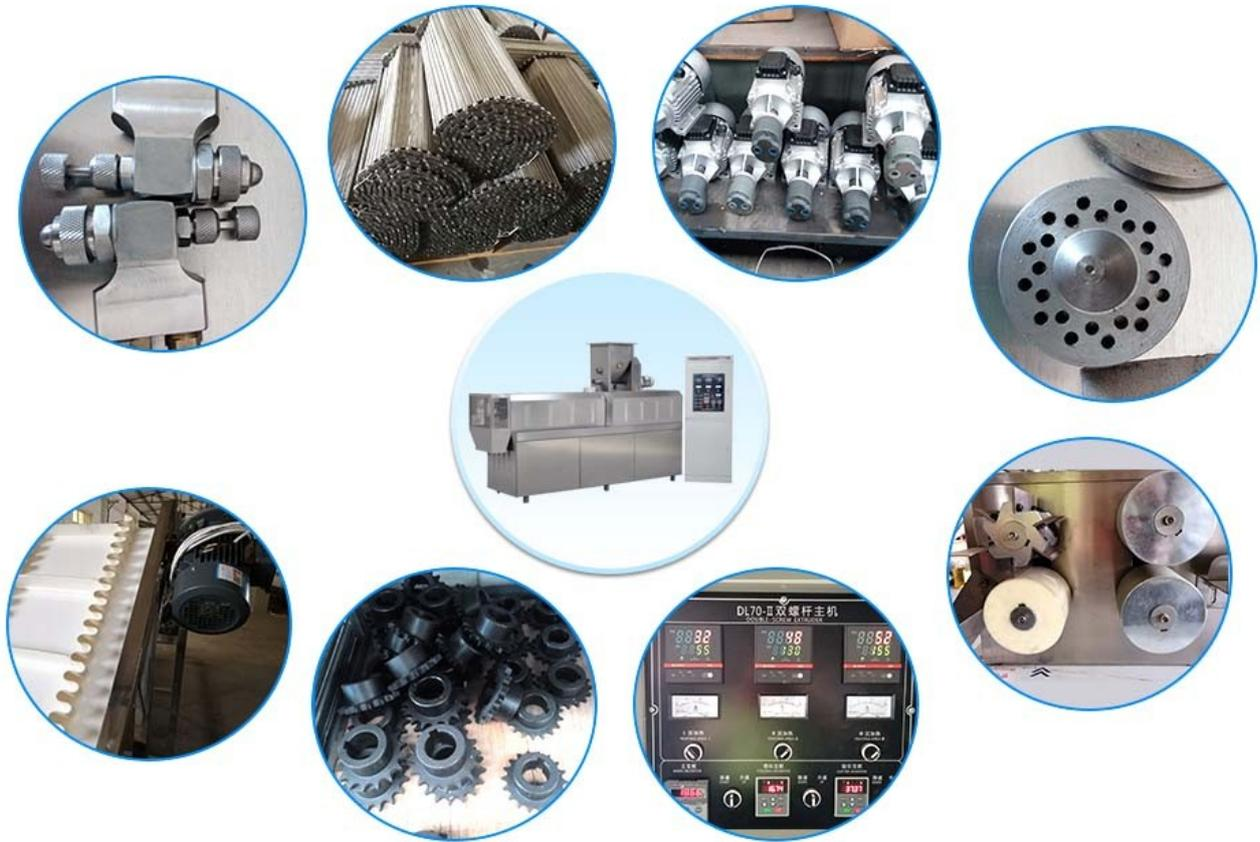
4. Antes de trabajar, desmonte la cabeza de la máquina, el movimiento, el tornillo y otras piezas de trabajo, limpie cuidadosamente la escala y el aceite del movimiento y el tornillo, límpielos, séquelos y vuelva a instalarlos.
