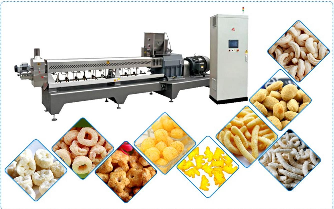
1. Cuando el surco en espiral se encuentre obstruido, no lo detenga inmediatamente. Deje de alimentarlo y hágalo funcionar por un tiempo hasta que tenga un olor a quemado. Esto puede evitar que la cabeza del aspersor y la manga espiral se atasquen. En caso de que la boquilla y la manga espiral no puedan ser retiradas debido a un ataque, no las golpee con fuerza. Puedes quitarlos del cuerpo y ponerlos en el fuego por un tiempo.
