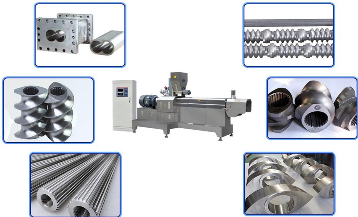
2. El sistema de alimentación de la extrusora industrial, el sistema de accionamiento principal y el sistema de corte rotativo adoptan la regulación de la velocidad por conversión de frecuencia. 3. Tiene una gran potencia, operación estable y ahorro de energía.
