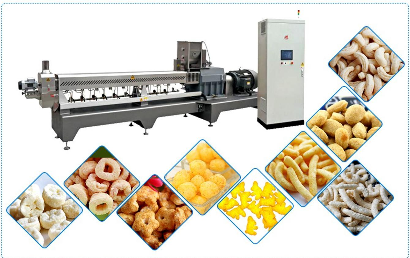
Actualmente, vendemos dos tipos de máquinas extrusoras de tornillos. Una es una extrusora de un solo tornillo. Y la otra es una máquina extrusora de doble tornillo. Comparada con la primera, la ventaja de la extrusora de doble tornillo es relativamente más obvia para la extrusión y expansión de la materia prima.
