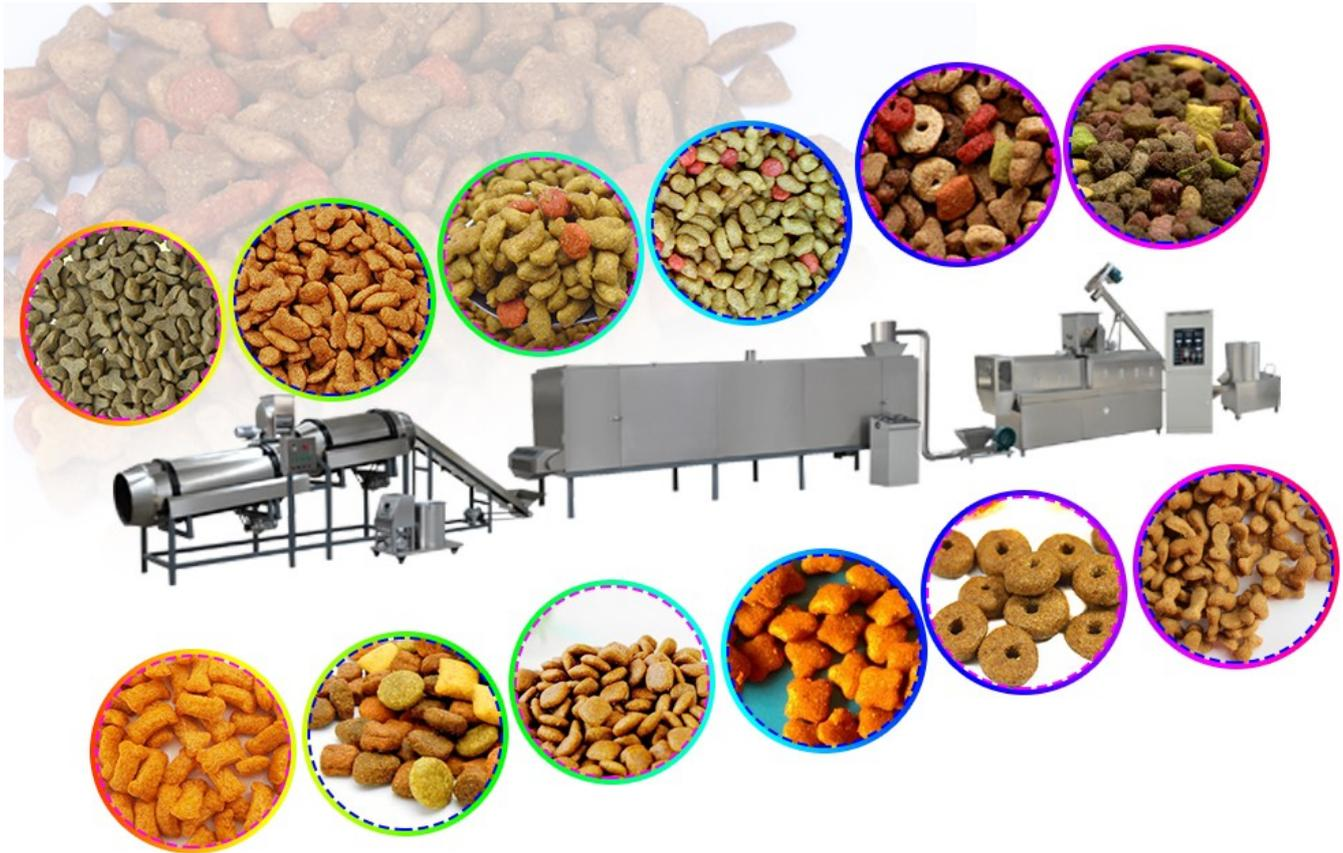
Su principal principio de funcionamiento es que la energía mecánica se convierte en energía térmica. El calor generado cuando la máquina gira se utiliza para exprimir y cocinar los alimentos. La característica más obvia de la comida de la extrusora de soplado es su mayor volumen.
