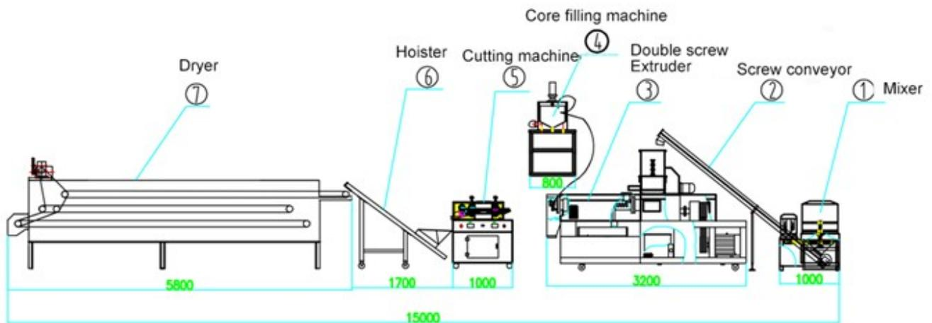
Utilizando el sistema de tornillo no estándar de distancia desigual de la extrusión, el gas del material se descarga y se llena rápidamente con el material. El material se somete a la fuerza de cizallamiento para producir el contraflujo, lo que aumenta la presión en la cámara. La fricción entre la pila y la cámara hace que los materiales se mezclen, expriman, calienten, peguen y gelatinicen completamente para producir cambios de organización, y la estructura original se destruye.
