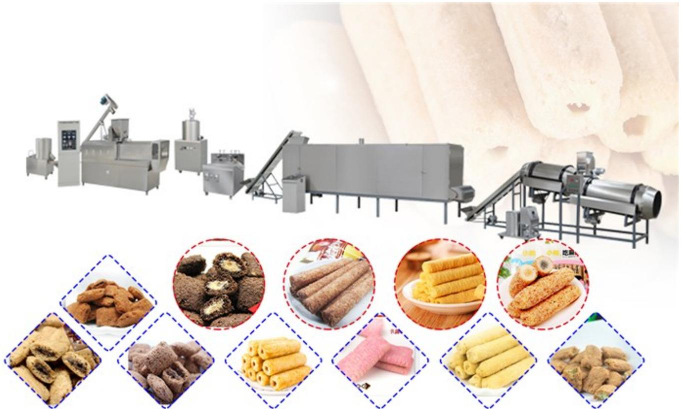
La máquina automática de soplado de maíz pertenece a un tipo de equipo para procesar alimentos soplados, como el procesamiento de arroz, maíz, soja, trigo, etc. en la vida diaria. Su principio de funcionamiento principal es que la energía mecánica se convierte en energía térmica. El calor generado cuando la máquina gira se utiliza para exprimir y cocinar los alimentos. La característica más obvia del bocadillo inflado es su mayor volumen.
