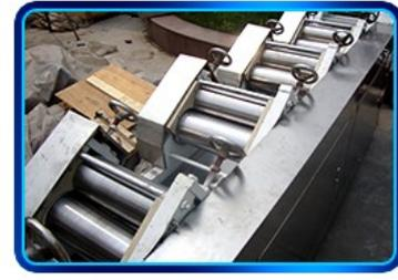
3.El sistema de transporte de la cinta de malla utiliza un motor de velocidad de conversión de frecuencia para accionar la cinta de malla. La velocidad de la cinta de malla puede ajustarse arbitrariamente para controlar el tiempo de fritura.
