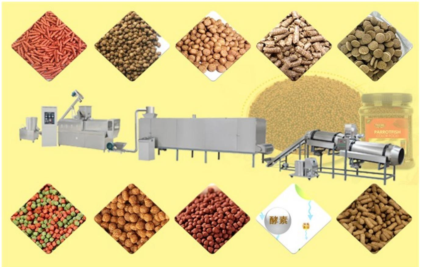
El equipo de producción de piensos tiene un diseño razonable, un alto grado de automatización y un control preciso de los parámetros del proceso de extrusión. La línea de producción de alimentos para peces flotantes industriales utiliza cereales integrales, harina de soja, harina de pescado, harina de huesos, harina de carne, etc. como las principales materias primas, y se
