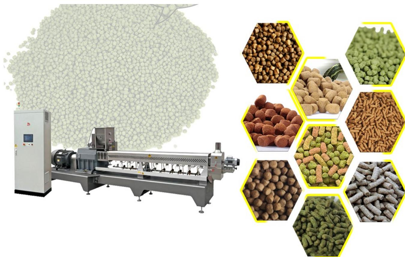
Debido a las características inherentes de la extrusora, el producto de alimentación extruido puede tener un cierto grado de efecto de inflado ajustando los parámetros de proceso de la extrusora.
