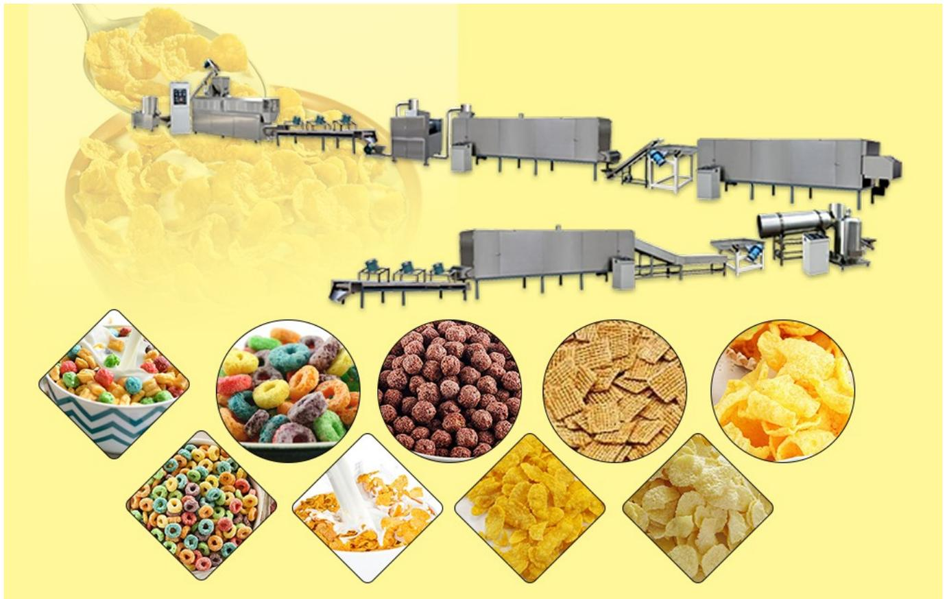
El material de los copos de maíz inflados es alimentado por el alimentador. Además, el barril se somete a alta temperatura, alta presión y alto cizallamiento, de modo que el material se
